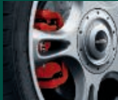
Sportbremse, 16 Zoll, mit gelochter und geschlitzter Bremsscheibe
