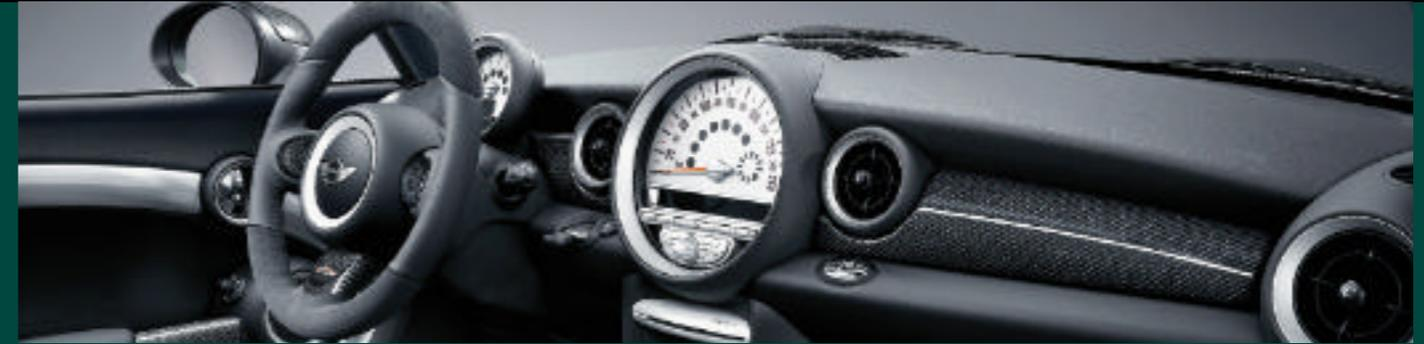
Für den letzten Schliff: Interieurleiste aus Carbon mit Lenkrad in Alcantara/Carbon.
