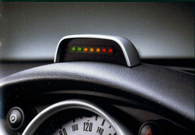
Auf Touren: der Gear Shift Indicator.
